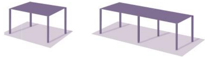
Estructura exenta de un módulo y cuatro postes. Estructura exenta de dos módulos y seis postes.
